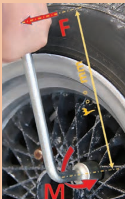
شکل ۵-۱۱- باز کردن پیچ چرخ خودرو توسط آچار چرخ
