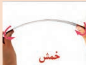
شکل ۵-۵- انواع بارگذاری روی نوار فلزی
