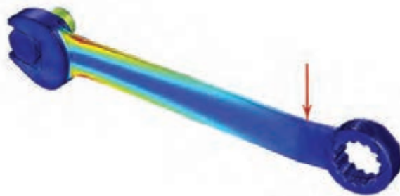
شکل ۵-۱۲- قسمت‌های بحرانی یک آچار هنگام بارگذاری
